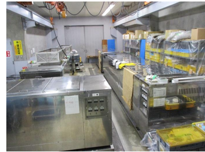
木器処理室のPEG含浸槽 (木製品を水溶性化合物に浸し、時間をかけて木材組織内の水分と置換 ⇒ 形状安定化)
