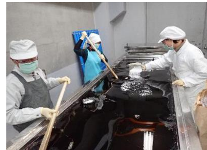
木器処理室のPEG含浸槽 (木製品を水溶性化合物に浸し、時間をかけて木材組織内の水分と置換 ⇒ 形状安定化)
